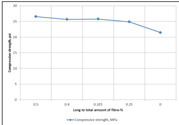
FIGURE 3. INFLUENCE OF LONG TO TOTAL FIBRE RATIO ON THE COMPRESSIVE STRENGTH AT 28 DAYS
