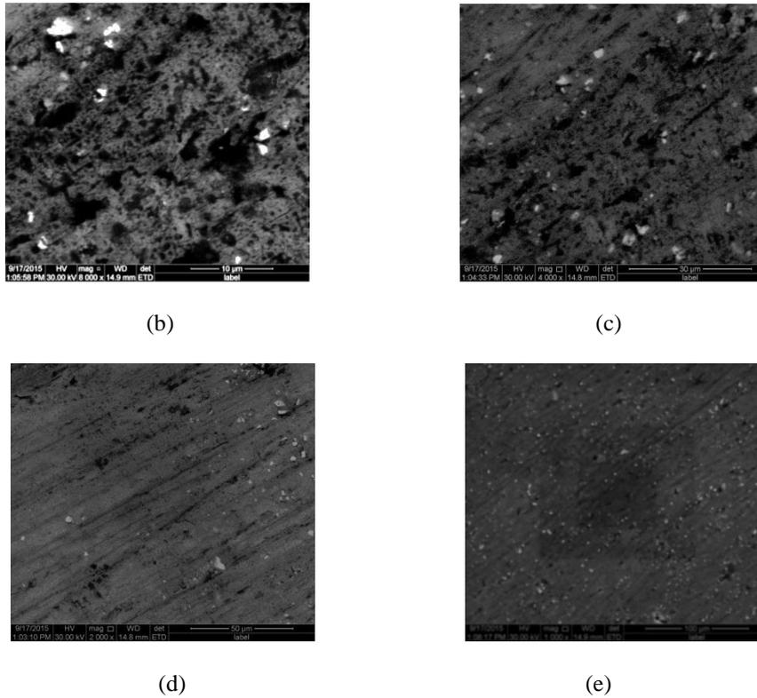
Figure 8. SEM micrographs of corroded samples of (a) Al 6061 matrix alloy, (b) Al 6061-SiC (3 wt %) composite, (c) Al 6061-SiC (6 wt %) composite, (d) Al 6061-SiC (9 wt %) composite and (e) Al 6061-SiC (12 wt %).
