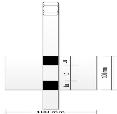
FIGURE 2 TESTING SPECIMEN DETAILS.
